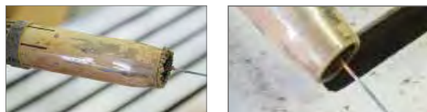
Zbytky ze svařování již na trysce neulpívají a lze je velmi snadno odstranit.
