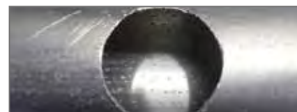
Poškozené místo odmastěte (např. pomocí 1-2-3 Fluid) a zdrsňte
