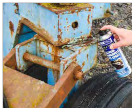
Vysokozatížené kluzné plochy na operách a otočných kloubech (ozubený věnec) na jeřábech a přívěsech
